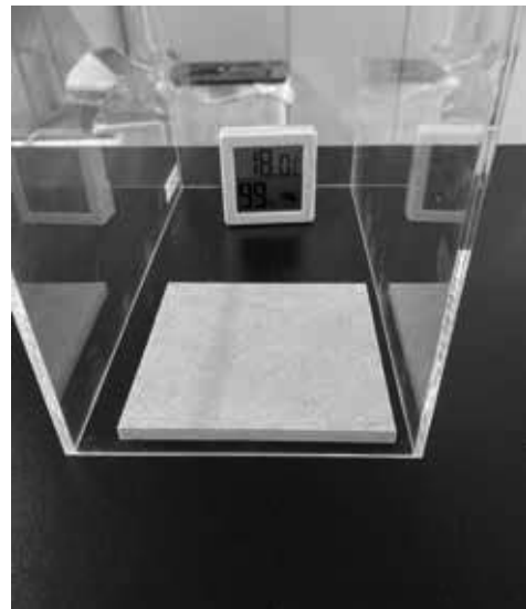
図 2. 漆喰を塗布していないコルク板
