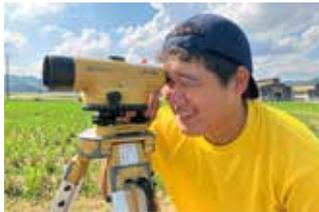
**1 年生：**クラスの数名が11月に行われる「危険物取扱者試験」を自主的に受験する予定で、12月からは5月に行われる「測量士補」の取得に向けてクラス全員で取り組みます。また実習では写真のように学校の農場で縦横断測量という測量の実習を行っています。
