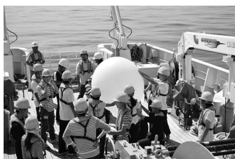
ヘリウムガスを入れて風船に「ラジオゾンデ」と呼ばれる計器をつけて飛ばし、上空の大気の状態を計測する
