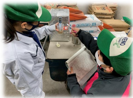
環境に配慮した発酵飼料の保存性試験 (pH測定試験の様子)
